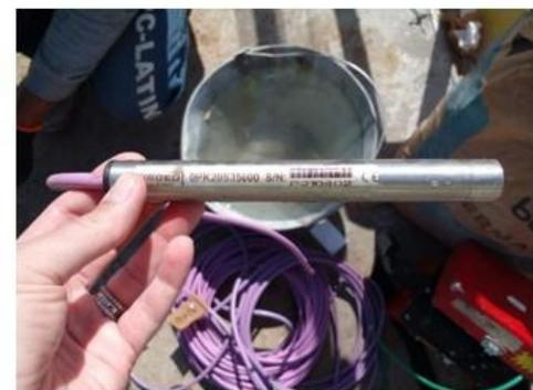
Figura 3. Piezômetro elétrico (PZE)
