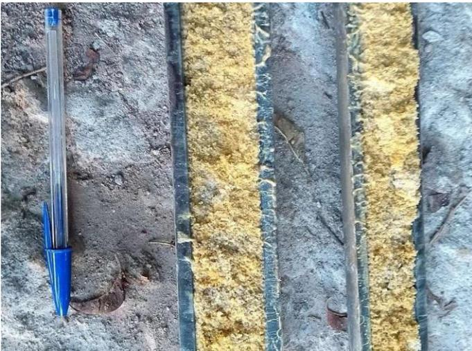
Figura 9. Amostra de solo arenoso da Fm. Resende coletada em sondagem executada na Estação São Bento.
