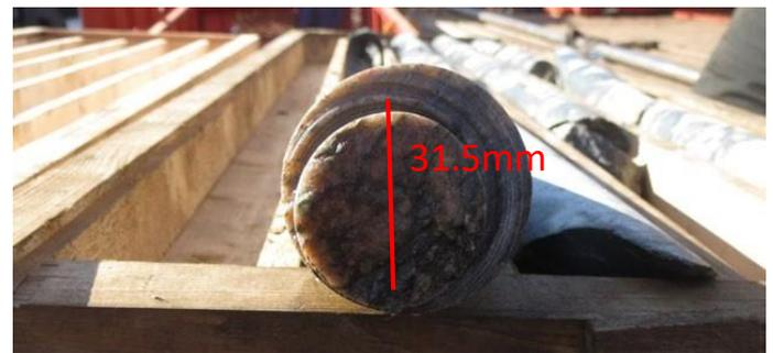
Figura 9. Diâmetro da amostra durante a execução da curva é de 31.5mm.
