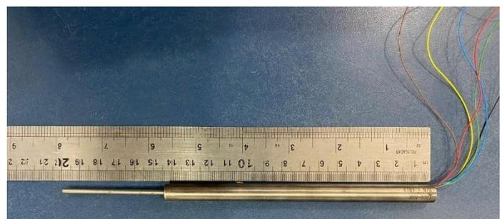
Figura 12. Instrumentação Usada nos Ensaio (LVDT).
