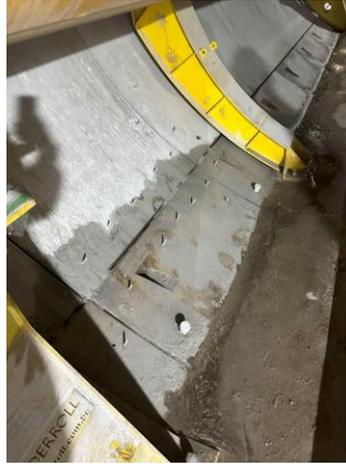
Figura 14 Bicos de injeção instalados
