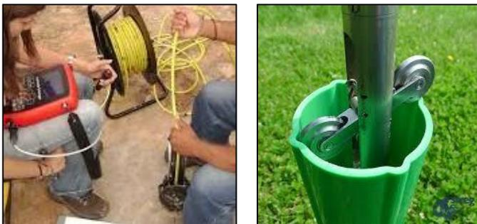
Figura 4. Inclinómetro
