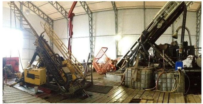
Figura 11. Duas plataformas de perfuração (sondas) trabalhando na ilha.
