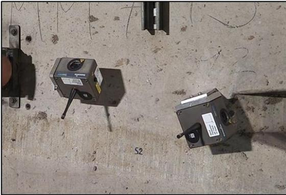
Figura 21. Detalhe dos nodos instalados
