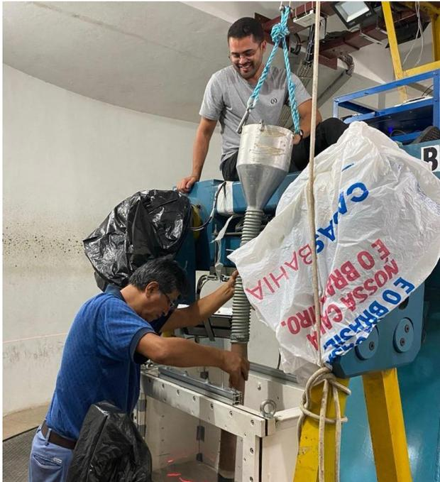
Figura 8. Processo de Pluviação na Caixa Teste da Centrífuga.
