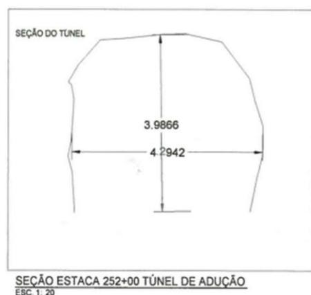
Figura 3. Exemplo da geometria efetiva de escavação do túnel observada após o esvaziamento (seção est. 252).
