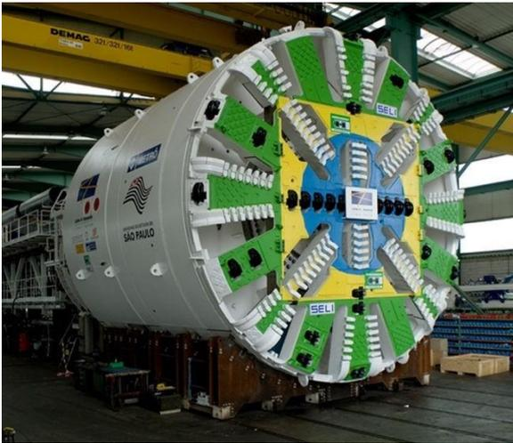
Foto 24. *Shield* alemão *Herrenknecht*, diâmetro 9,46 m utilizado nas obras da Linha 4 amarela do Metrô. Fonte: *Herrenknecht do Brasil* (Eng. Edson Peev).
