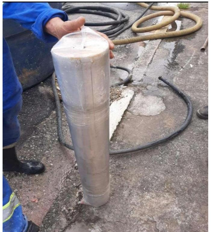
Figura 7. Barrilete com amostra indeformada de solo residual, parafinado, para transporte ao laboratório de ensaios triaxiais do VSE Adolf Schindling.
