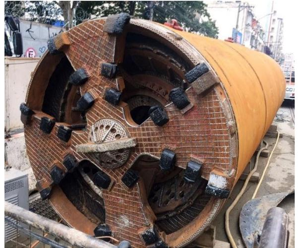
Foto 17. *Shield Pipe Jacking*, modelo AVN *Herrenknecht* diâmetro 1,80 m utilizado nas obras do ITi-7 em 2018. Fonte: Telar Engenharia
