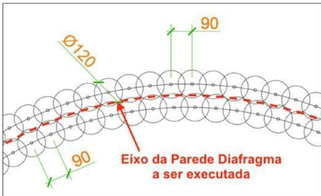
Figura 16 Detalhe das colunas ao redor do alinhamento da Parede Diafragma
