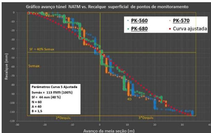
Figura 12: Exemplo de recalque medido na superfície do solo acima do eixo do túnel em função da distância da face do túnel e curva  $S$  ajustadas num Túnel NATM do Metrô de São Paulo (gráfico obtido pelo autor).
