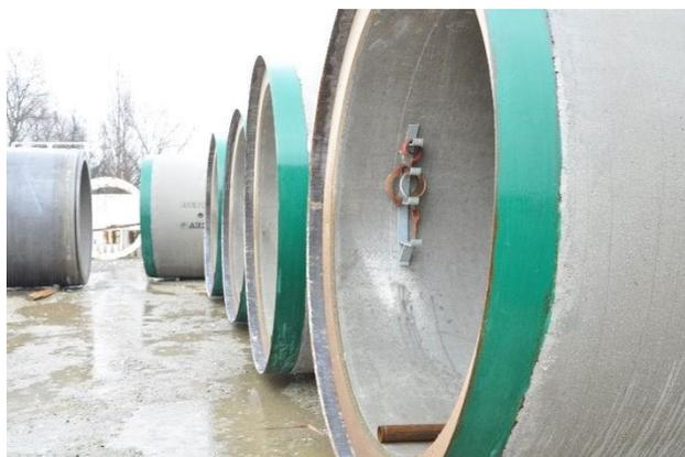
Foto 15. Tubo PJ diâmetro 2,00 m onde se vê a chapa metálica (em verde) incorporada no próprio concreto. Fonte: acervo próprio do autor
