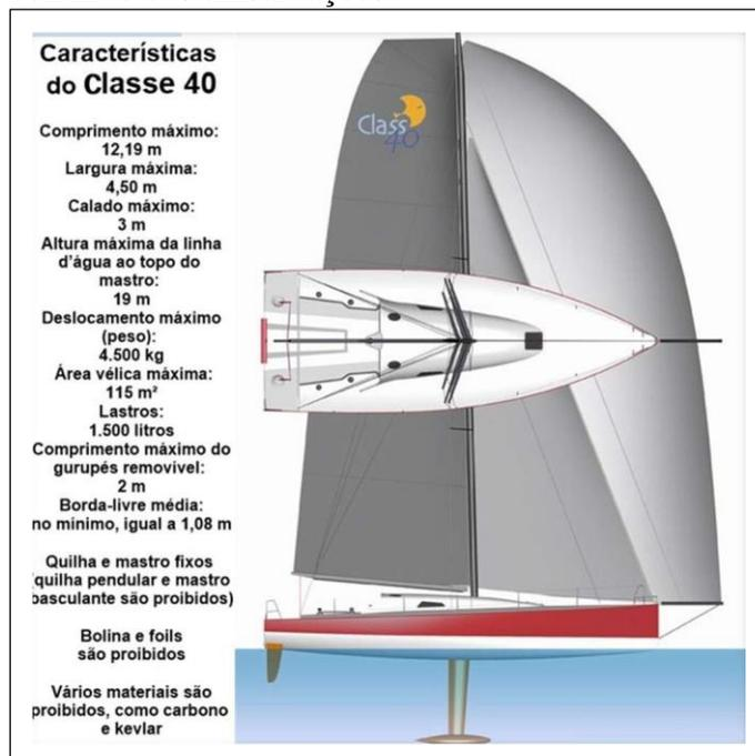
Figura 4. Altura de barcos Classe 40: 19 metros de mastro (Dottori, 2024)
