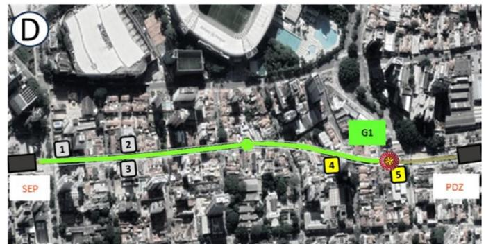
Figura 13. Trecho tipo de TBM entre as estações SESC-Pompeia (SEP), Perdizes (PDZ), com 5 edifícios com instrumentação automatizada.
