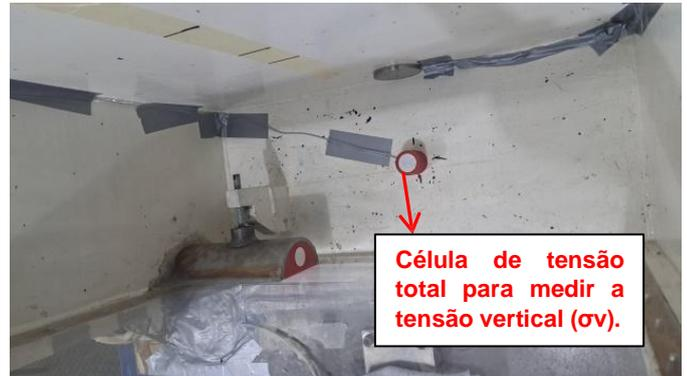
Figura 10. Instrumentação Usada nos Ensaio.
