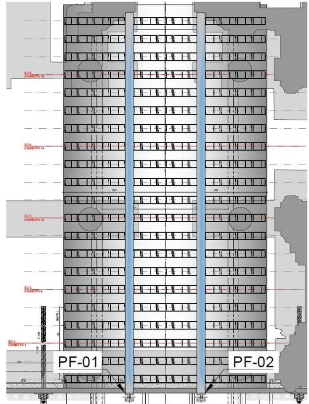
Figura 22 - Instrumentação do túnel – Planta indicando as 5 seções internas de monitoramento e os 2 perfilômetros.
