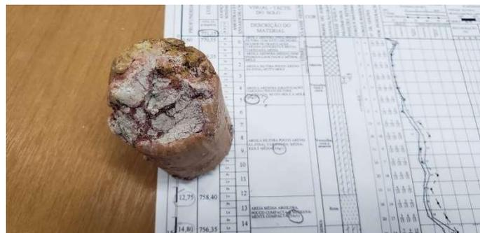
Figura 2. Análise tátil visual dos testemunhos de sondagem.
