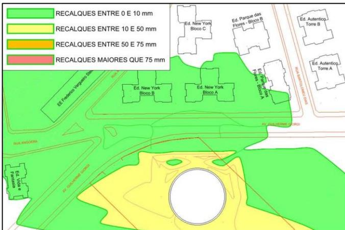
Figura 9. Bacia de recalques com os dados de instrumentação até a data de conclusão de escavação do poço.
