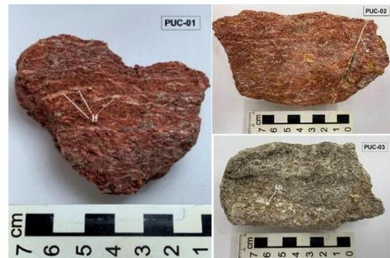
Figura 2: Amostra de solo residual de gnaíse (PUC-01), saprólito de gnaíse (PUC-02) e saprólito de xisto (PUC-03).
