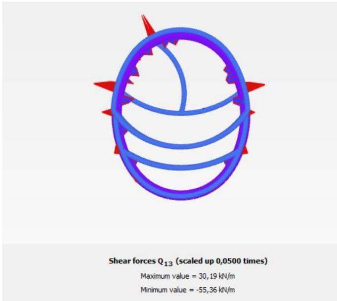
Figura 18. Esforços internos - Tensões de cisalhamento obtidos no revestimento para o modelo 3D.
