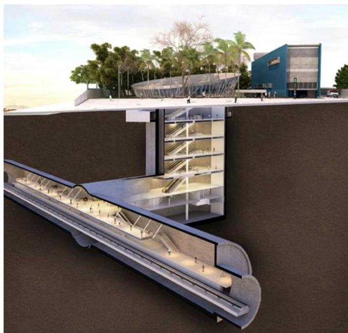
Figura 8. Layout da estação Santa Isabel composta por poço, túnel de ligação e túnel de estação.
