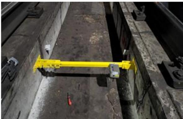
Figura. 17. Instalação nos trilhos do clinômetro+distanciômetro na barra articulada
