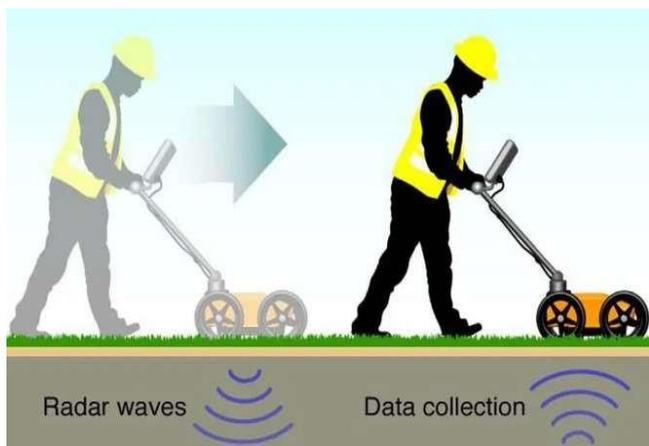
Figura 1. Execução do GPR (Struktur Audit Indonésia, 2020).
