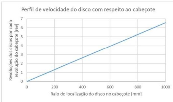
Figura 8. Perfil de velocidade dos discos com respeito ao giro do cabeçote
