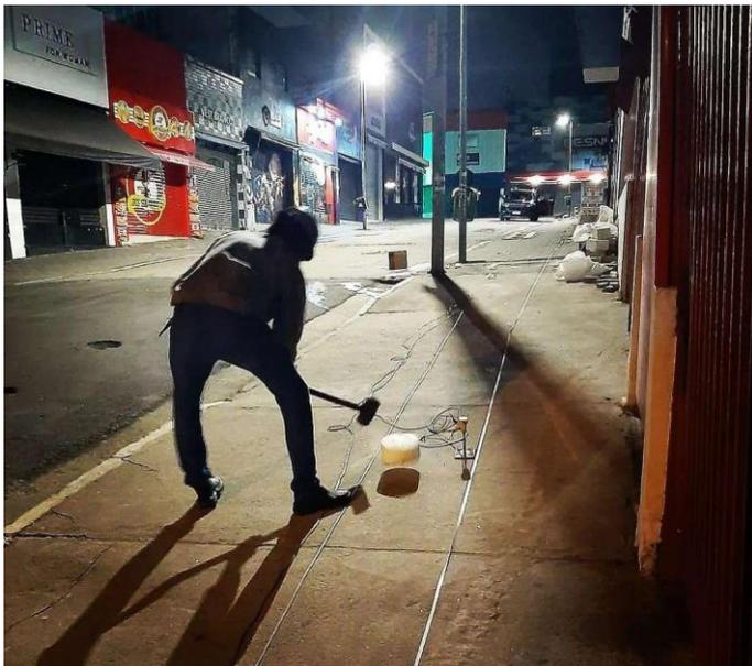
Figura 5. Etapa de energização em ensaio sísmico realizado em período noturno para atenuação de ruídos urbanos.
