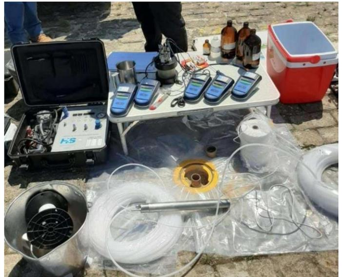
Figura 3. Coleta de água por sistema de baixa vazão para ensaios de caracterização ambiental no VSE Fernão Dias.
