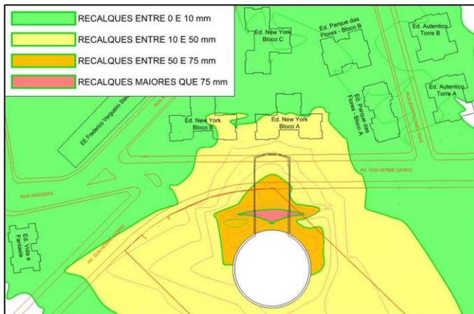
Figura 15. Bacia de recalques com os dados de instrumentação até a data de conclusão de escavação do túnel de ligação.
