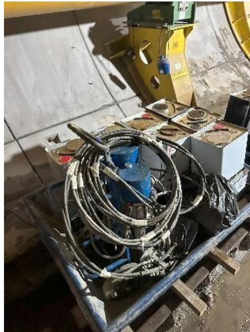
Figura 8 Teste dos equipamentos de injeção no túnel
