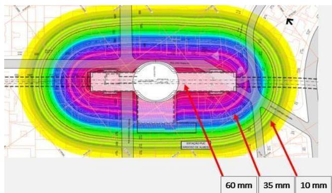
Figura 9 – Mapa de recalques estimados devido à escavação dos túneis do corpo da estação.
