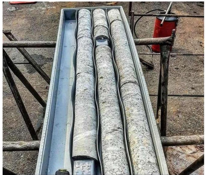
Figura 10. Testemunhos de rocha pré-cambriana coletada em sondagem rotativa realizada no VSE Fernão Dias.
