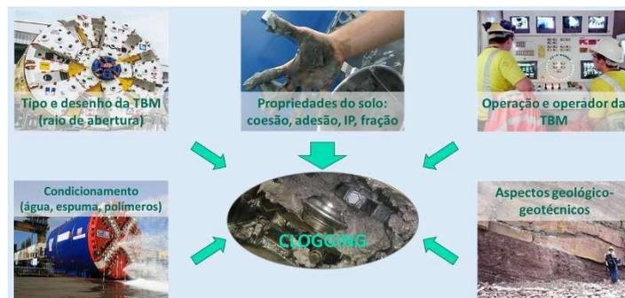
Figura 8 – Combinação de fatores que afetam a ocorrência de clogging em uma escavação.
