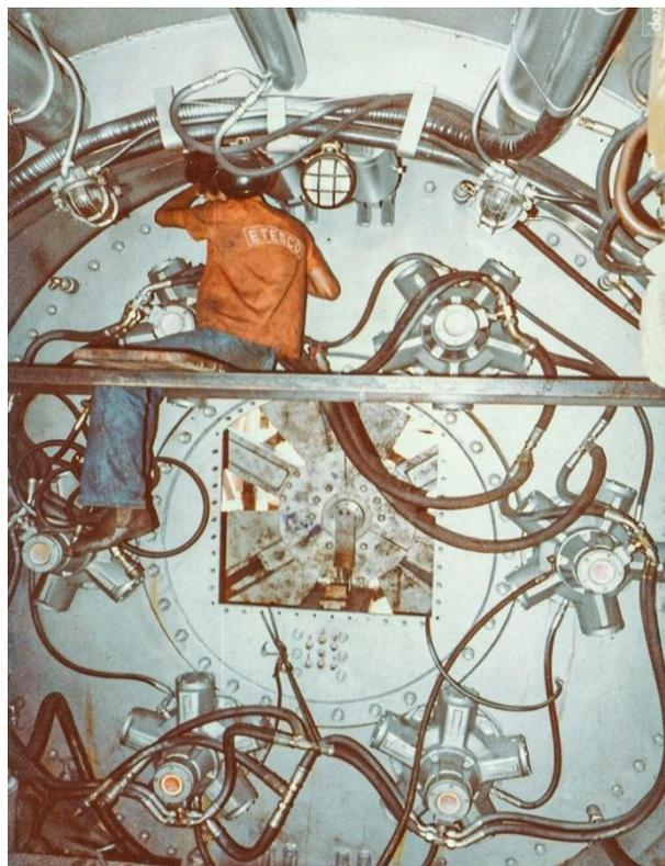
Foto 10. Fabricação do *Shield* Lomec de 3,00 m de diâmetro. Fonte: acervo próprio do autor.
