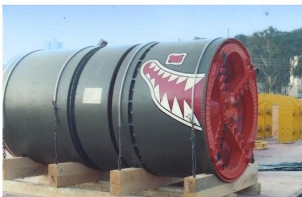
Foto 13. *Shield Pipe Jacking* japonês utilizado nas obras da CEDAE no Rio de Janeiro. Fonte: Construtora Passarelli
