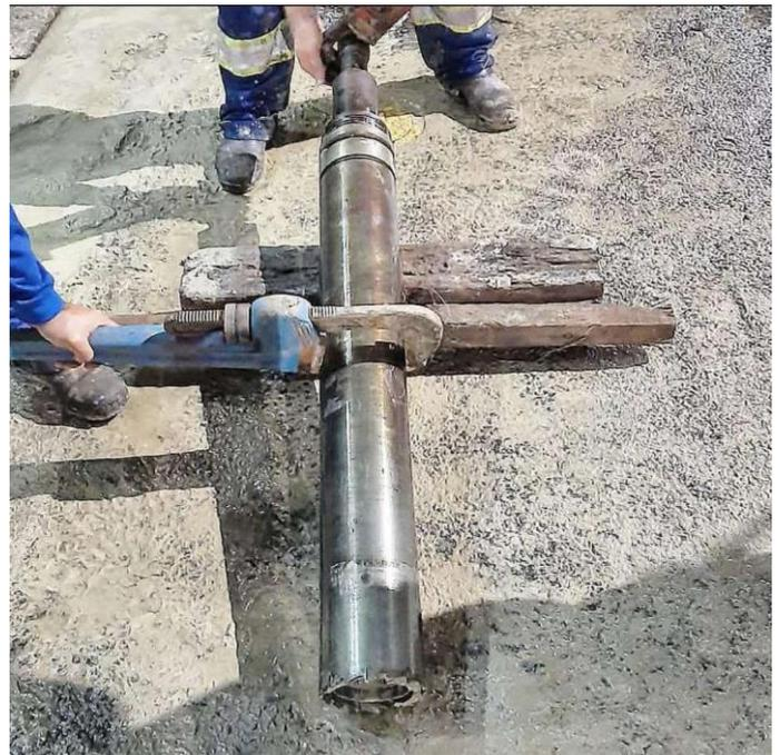
Figura 6. Amostrador dinâmico Denison em uso em coleta de amostra indeformada na Estação Pari-Cerealista.
