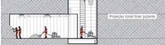
Figura 4. Desenho esquemático do Poço de Ataque. (Fonte: ARMCO STACCO)
