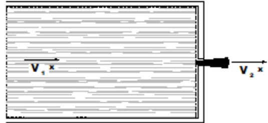
Figura 1. Volume de Controle, com velocidades antes e após a saída por um orifício.  $V_{2x} \gg V_{1x}$ .
