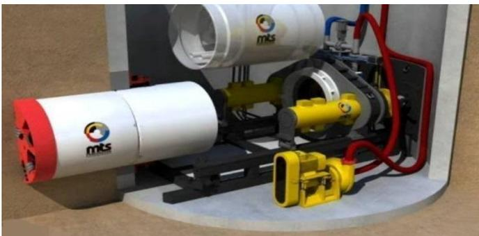
Figura 8. Modelo de micro tuneladora horizontal.
